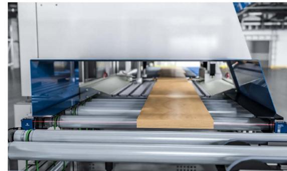
**使用三角测量法激光测距传感器测量镶木地板的宽度**
