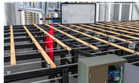
**使用 2D/3D 轮廓传感器对木板长度进行成列测量**
