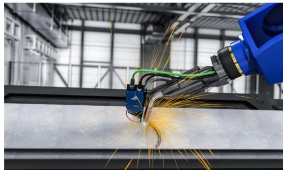
**在机器人单元中使用 2D/3D 轮廓传感器进行焊缝导向**
