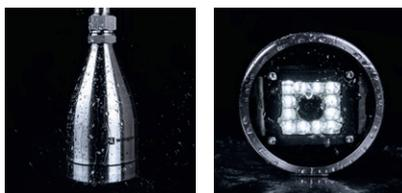
L'**alloggiamento protettivo** per weQube con messa a fuoco automatica della serie di prodotti InoxSens di wenglor permette l'impiego in settori industriali sensibili a livello igienico. L'alloggiamento saldato al laser in acciaio inox V4A soddisfa gli elevati requisiti del **grado di protezione IP69K**. Il design garantisce uno scarico ottimale dei fluidi dalla superficie.
